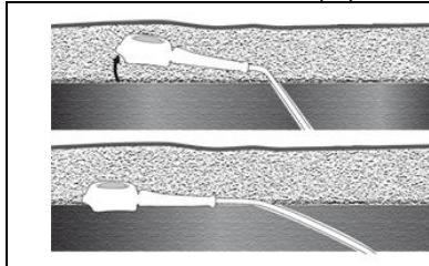
**Errato passaggio del catetere:** il catetere può generare una forza di leva nella camera e portare alla rotazione di quest'ultima.
